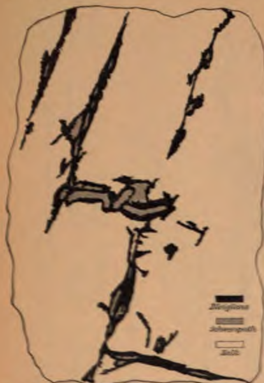
Fig. 24. Metasomatische Erze im Kalk, den Schichtflächen und Klufsystemen folgend. (Wapfeld. Z. f. pr. Geol. 1897 S. 207.)
